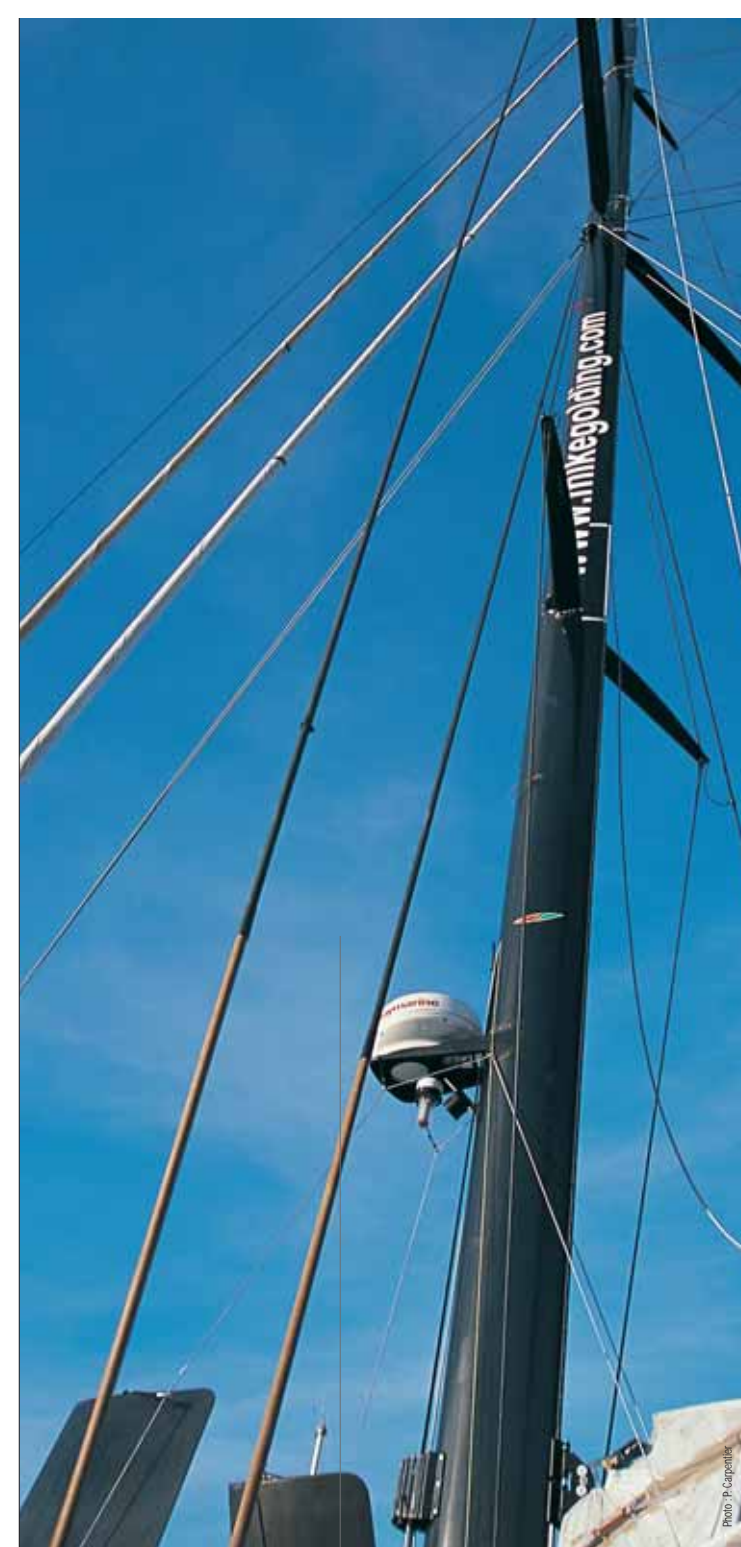
Le gréement d'Ecover intégralement en composite.
