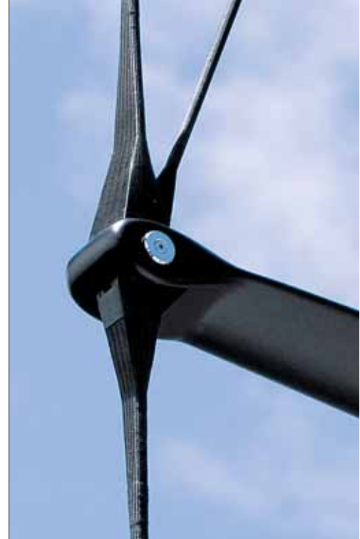
Gréement discontinu en PBO. (Source Futures Fibres)
