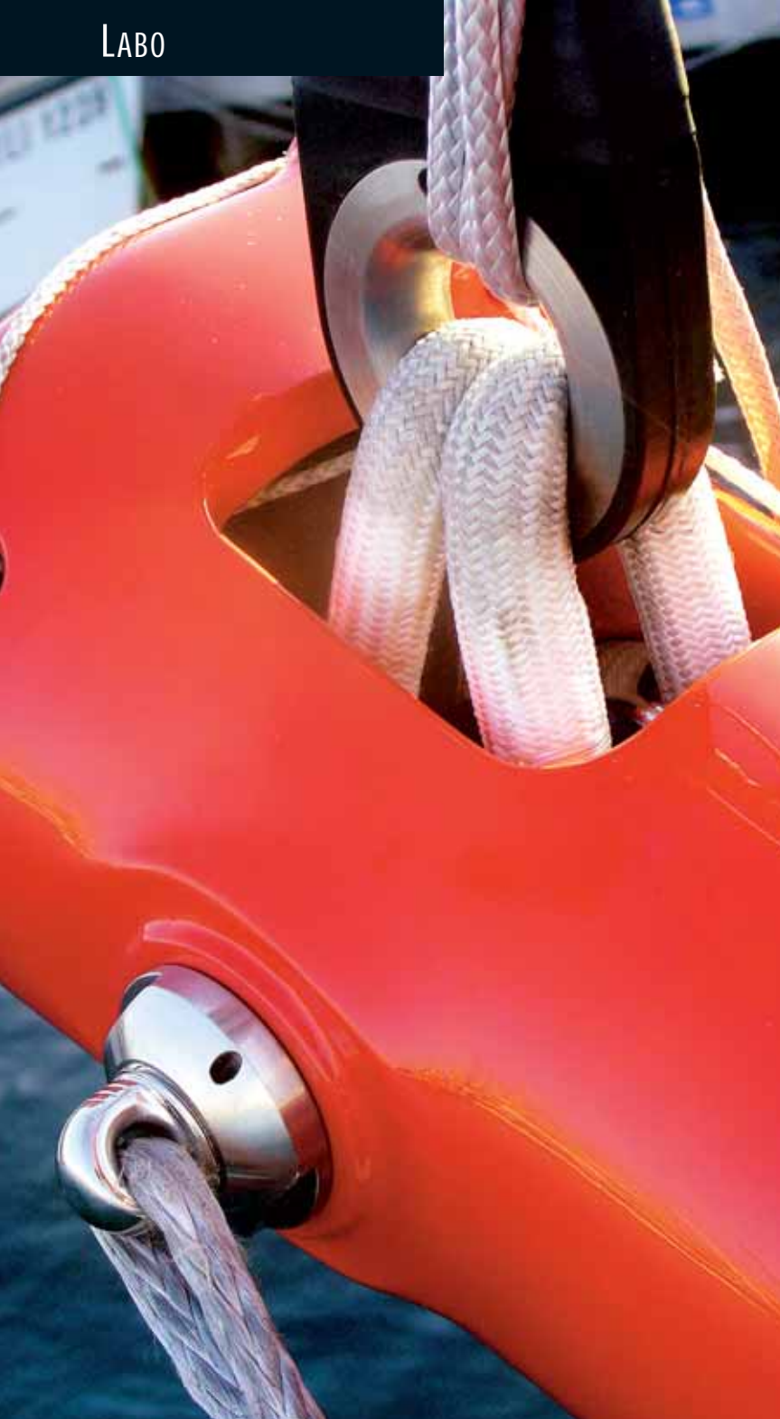
Détail d'accroche de hauban en pointe d'un outigger Groupe Bel. (Source Blew Stoub)
